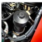
Улучшенное размещение фильтров гидравлической системы.
